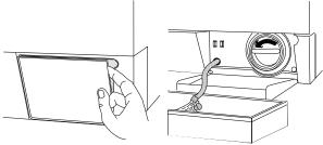
estrarre il tubicino di scarico acqua dal suo alloggiamento, porlo nella bacinella e togliere il tappo. Quando l'acqua non fuoriesce più, svitare e togliere il coperchietto della pompa. Tenere a portata di mano uno straccio per asciugare eventualmente l'acqua che dovesse fuoriuscire quando si svita il coperchietto.
