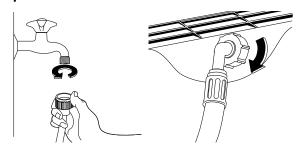
in qualsiasi direzione. Svitare leggermente la ghiera di fissaggio, girare l'estremità del tubo e riavvitare la ghiera, controllando che non ci siano perdite d'acqua.
