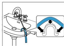
Fissare e assicurare il raccordo di scarico dell'acqua con un collettore.
