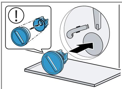
5. Chiudere il coperchio della pompa ruotandolo finché non si innesta.
