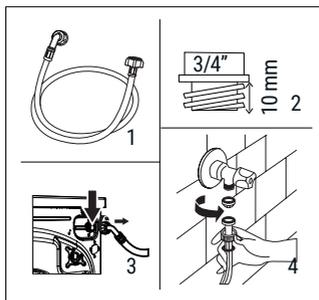
**1)** A seconda delle specifiche della macchina, quest'ultima può disporre di una singola connessione di ingresso dell'acqua (fredda) o di una doppia connessione (calda e fredda). Se il tubo di entrata dell'acqua non è già installato, deve essere avvitato all'apparecchio. Il tubo con tappo blu deve essere collegato all'ingresso dell'acqua fredda e il tubo con tappo rosso all'ingresso dell'acqua calda (se applicabile).
