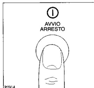
Premere il tasto AVVIO ARRESTO, la lampada spia di funzionamento e quella della porta si accendono e la macchina entra in funzione.
