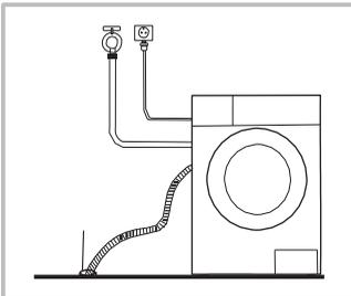
2. Collegarla al tubo di scarico del pozzetto.
