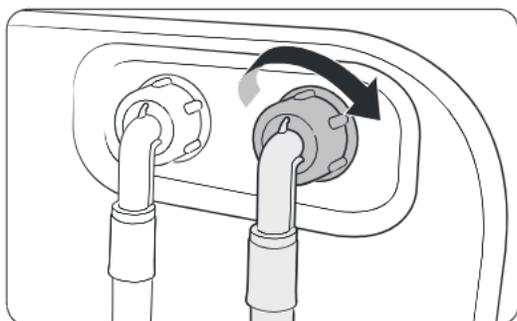
1. Collegare il terminale rosso del tubo di carico dell'acqua calda all'ingresso dell'acqua calda sul retro della lavatrice.
