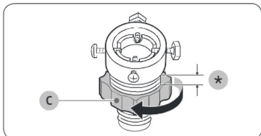
3. Afferrare l'adattatore e ruotare la **parte (C)** in direzione della freccia per svitarlo di 5 mm (\*).
