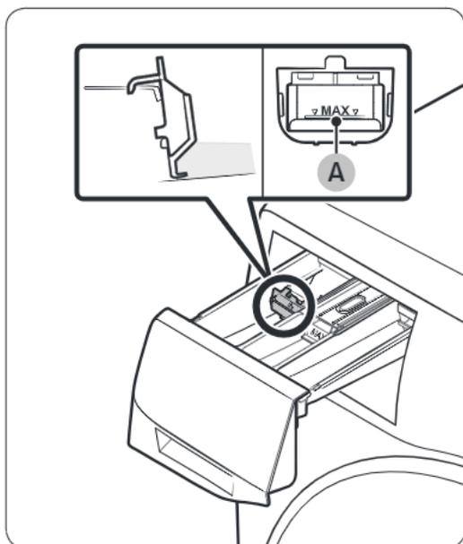
Inserire per primo il contenitore per liquidi in dotazione nello **II** scomparto lavaggio principale. Quindi, versare il detersivo liquido nel contenitore sotto la **linea max (A)**.
