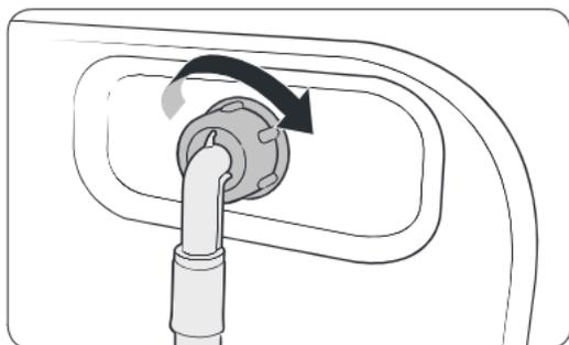
1. Collegare il tubo al rubinetto dell'acqua quindi ruotare il connettore il senso orario come mostrato in figura.
