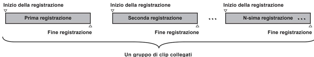
\* Si possono collegare un massimo di 99 registrazioni. Al termine della 99a registrazione, il collegamento dei clip termina automaticamente e la lettura successiva è un nuovo clip.
