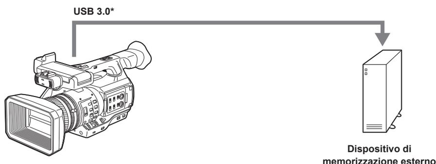
\* Con la videocamera non viene fornito alcun cavo USB 3.0. Utilizzare un cavo USB 3.0 commerciale (con schermatura doppia per la riduzione dei disturbi).
