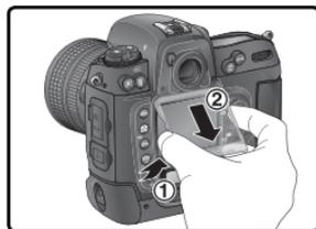
Per rimontare la copertura protettiva sul monitor, inserite le due linguette superiori nelle relative feritoie sopra alla cornice del monitor (1), quindi premete la parte bassa del coperchio finché si posiziona con uno scatto (2).
