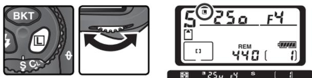
Per rimuovere il blocco, premete il pulsante **L** e ruotate la ghiera principale finché le icone di blocco scompaiono dai display.
