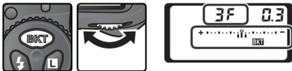
3 Premendo il pulsante **BKT**, ruotate la ghiera secondaria per selezionare l'entità di variazione dell'esposizione (☞ 100–102).
