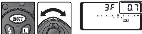
4 Componete l'inquadratura, mettete a fuoco e scattate. La fotocamera varierà l'esposizione e/o l'intensità flash per i vari scatti in base al programma bracketing selezionato. Le variazioni di esposizione si sommano al valore di compensazione eventualmente inserito, rendendo possibile l'ottenimento di valori di compensazione superiori a 5 EV.
