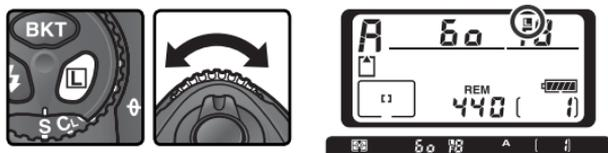
Per rimuovere il blocco, premete il pulsante **L** e ruotate la ghiera secondaria finché le icone di blocco scompaiono dai display.
