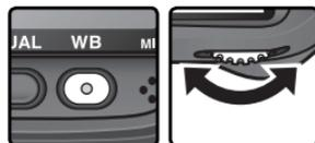
Se il nuovo valore di bilanciamento del bianco Preset verrà utilizzato subito, selezionate il cassetto d-0 premendo il pulsante **WB** e ruotando la ghiera secondaria fino a far comparire d-0 sul pannello posteriore (61). In caso contrario, quando si misura un nuovo valore per il bilanciamento del bianco non è necessario selezionare d-0.
