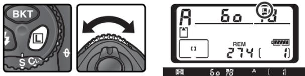
Per rimuovere il blocco, premete il pulsante
