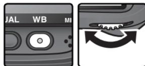
Se il nuovo valore di bilanciamento del bianco Premisurato verrà utilizzato subito, selezionate il cassetto d-0 premendo il pulsante **WB** e ruotando la ghiera secondaria fino a far comparire d-0 sul pannello posteriore (63). In caso contrario, quando si misura un nuovo valore per il bilanciamento del bianco non è necessario selezionare d-0.
