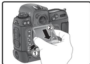
Per rimontare la copertura protettiva sul monitor, inserite le due linguette superiori nelle relative feritoie sopra alla cornice del monitor (①), quindi premete la parte bassa del coperchio finché si posiziona con uno scatto (②).
