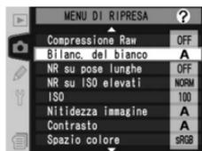
**2** Evidenziate l'opzione desiderata e premete il multi-selettore a destra. Se selezionate **Temperatura di colore** viene visualizzato un menu di temperature di colore (58); se selezionate **Bilanc. premisurato**, viene visualizzato un menu di bilanciamento del bianco con opzioni preselezionate (59); selezionando altre opzioni, potrete visualizzare una finestra di dialogo per la regolazione (56).
