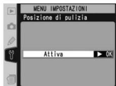
Evidenziando questa opzione e premendo il multi-selettore verso destra viene visualizzato il menu mostrato sopra. Se il multi-selettore viene premuto ancora verso destra, comparirà una fila di trattini ("---- --") nel pannello di controllo superiore. Per sollevare lo specchio, premete il pulsante di rilascio dell'otturatore. Lo specchio verrà bloccato in posizione sollevata e la fila di trattini lampeggerà. Lo specchio viene abbassato quando spegnete la fotocamera.
