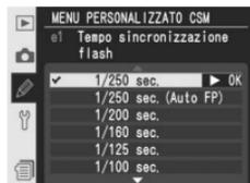
Evidenziate **e1 Tempo sincro flash** nel secondo livello del menu CSM (181) e premete il multi-selettore a destra. Premetelo in alto o basso per evidenziare un'opzione, quindi a destra per porre in atto la selezione.
