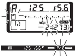
3 Premendo il pulsante **BKT**, ruotate la ghiera secondaria per scegliere la regolazione di bilanciamento del bianco (
