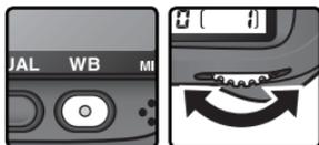
Se il nuovo valore di bilanciamento del bianco Premisurato verrà utilizzato subito, selezionate il cassetto d-0 premendo il pulsante **WB** e ruotando la ghiera secondaria fino a far comparire d-0 sul pannello posteriore (📷 64). In caso contrario, quando si misura un nuovo valore per il bilanciamento del bianco non è necessario selezionare d-0.
