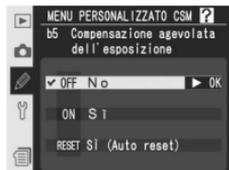
Evidenziate **b5 Comp. esposizione** nel secondo livello del menu CSM (📷 180) e premete il multi-selettore a destra. Premetelo in alto o basso per evidenziare un'opzione, quindi a destra per porre in atto la selezione.
