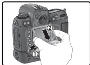
Per rimontare la copertura protettiva sul monitor, inserite le due linguette superiori nelle relative feritoie sopra alla cornice del monitor (1), quindi premete la parte bassa del coperchio finché si posiziona con uno scatto (2).
