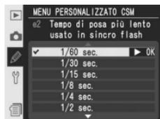
Evidenziate **e2 Minimo sincro flash** nel secondo livello del menu CSM (181) e premete il multi-selettore a destra. Premetelo in alto o basso per evidenziare un'opzione, quindi a destra per porre in atto la selezione.
