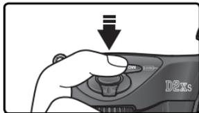
**5** Completate la pressione del pulsante di scatto a fondo corsa per acquisire i dati di riferimento Image Dust Off (tenete presente che la riduzione disturbi entra in funzione automaticamente se il soggetto è scarsamente illuminato, e quindi aumenta il tempo necessario alla registrazione dei dati). Quando viene premuto il pulsante di scatto il monitor si spegne.
