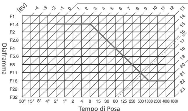
I valori massimi e minimi per EV variano a seconda della sensibilità ISO. I valori del grafico sopra riportato si riferiscono a una sensibilità equivalente a ISO 100. Quando si utilizza la misurazione Matrix, i valori superiori a 16  $\frac{1}{3}$  EV vengono riportati a 16  $\frac{1}{3}$  EV.
