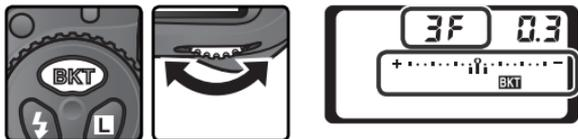
3 Premendo il pulsante **BKT**, ruotate la ghiera secondaria per selezionare l'entità di variazione dell'esposizione (☞ 102–104).
