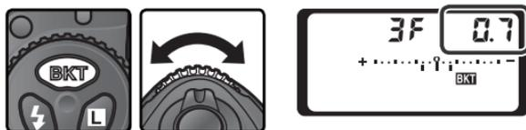
4 Componete l'inquadratura, mettete a fuoco e scattate. La fotocamera varierà l'esposizione e/o l'intensità flash per i vari scatti in base al programma bracketing selezionato. Le variazioni di esposizione si sommano al valore di compensazione eventualmente inserito (☞ 99), rendendo possibile l'ottenimento di valori di compensazione superiori a 5 EV.
