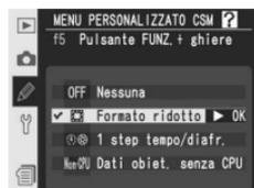
2 Premete il pulsante FUNC. e ruotate la ghiera di comando principale fino a quando l'indicatore Formato ridotto 8 fps non verrà visualizzato nel pannello di controllo superiore.
