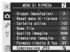
**2** Evidenziate l'opzione desiderata e premete il multi-selettore a destra. Ricomparirà il menu di ripresa. L'opzione selezionata ha effetto ogni volta che la qualità d'immagine è impostata su **NEF (RAW)+JPEG Fine**, **NEF (RAW)+JPEG Normal**, **NEF (RAW)+JPEG Basic**, **JPEG Fine**, **JPEG Normal** o **JPEG Basic**.
