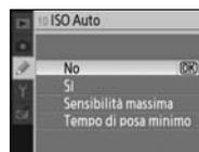
Se è selezionato **Sì**, nel mirino e nel display dati di ripresa verrà visualizzato **ISO-AUTO**. Questi indicatori lampeggiano quando la sensibilità viene modificata rispetto al valore da voi selezionato, se non utilizzate un flash. Con valori di sensibilità ISO elevati è più probabile che si verifichino disturbi.
