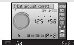
Se viene visualizzato l'avviso riportato a destra, la fotocamera non è stata in grado di misurare il bilanciamento del bianco. Ritornate al passaggio 2 e misurate nuovamente il bilanciamento del bianco.
