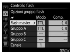
Se **AWL ottica** o **AWL ottica/radio** è selezionato per **Controllo flash** > **Opzioni flash wireless** nel menu di ripresa foto (📖 292), scegliere un canale per il flash master.
