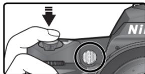
Affinché l'illuminatore ausiliario AF possa funzionare correttamente, l'obiettivo deve avere una lunghezza focale compresa tra 24 e 200mm, e il soggetto deve trovarsi nel campo utile dell'illuminatore. Il paraluce va rimosso. Con la maggior parte delle ottiche, la portata dell'illuminatore è di circa 0,5-3 metri. Con gli obiettivi elencati sotto, l'autofocus con illuminazione di assistenza AF non è disponibile a distanze inferiori ad 1 metro:
