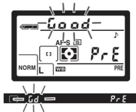
Se la luce non è sufficiente oppure eccessiva, la fotocamera può non essere in grado di misurare il bilanciamento del bianco. In tal caso sul pannello di controllo e nel mirino compare l'indicazione **no Gd** lampeggiante. Ritornate al punto 4 ed eseguite un nuovo tentativo.
