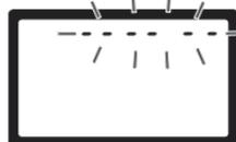
**3** Premete il pulsante di scatto a fondo corsa. Lo specchio si solleva e la tendina dell'otturatore si apre permettendo l'accesso al filtro low-pass, mentre la fila di trattini sul pannello di controllo inizia a lampeggiare.
