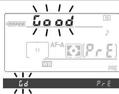
Se i display lampeggiano come mostrato a destra, significa che la fotocamera non è stata in grado di misurare il bilanciamento del bianco. Premete il pulsante di scatto fino a metà corsa per ritornare al passaggio 4 e ripetere la misurazione.
