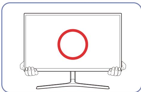
Spostare il monitor tenendolo per la parte inferiore.
