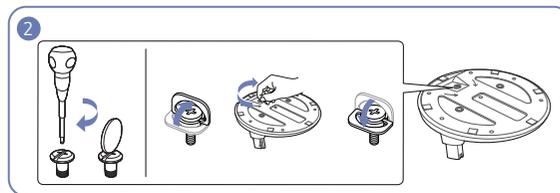
Ruotare completamente le viti di collegamento posta sul fondo del piedistallo in modo da fissarlo saldamente.
