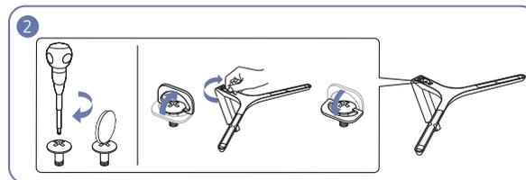
Ruotare completamente la vite di collegamento posta sul fondo del piedistallo in modo da fissarlo saldamente.
