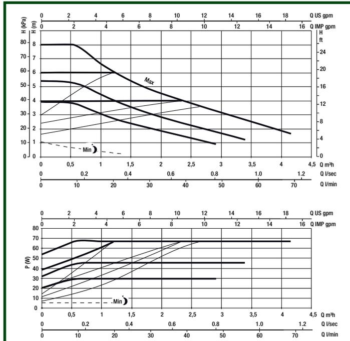
Le curve di prestazione sono basate su valori di viscosità cinematica = 1 mm<sup>2</sup>/s e densità pari a 1000 kg/m<sup>3</sup>. Tolleranza delle curve secondo ISO9906.
