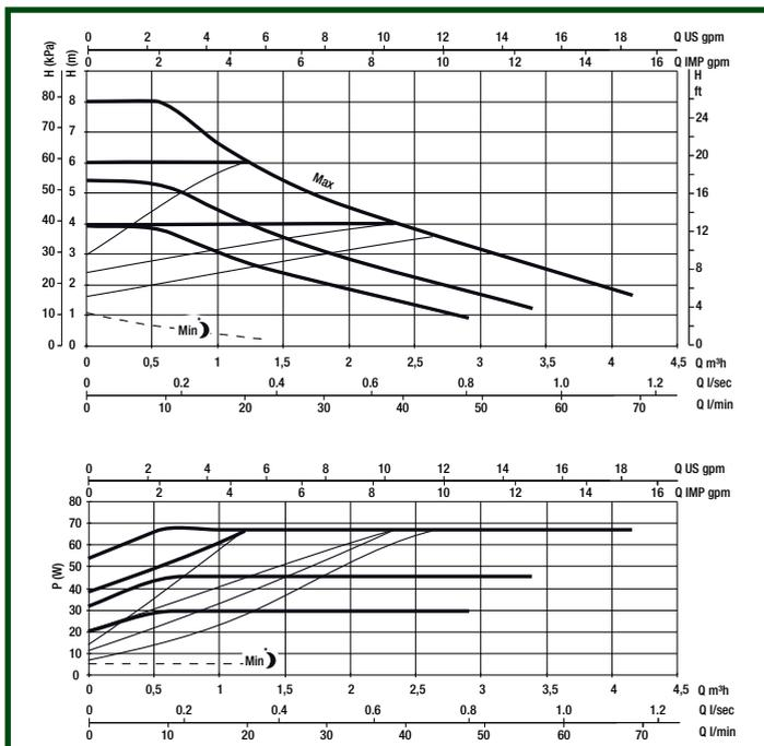
Le curve di prestazione sono basate su valori di viscosità cinematica = 1 mm<sup>2</sup>/s e densità pari a 1000 kg/m<sup>3</sup>. Tolleranza delle curve secondo ISO9906.
