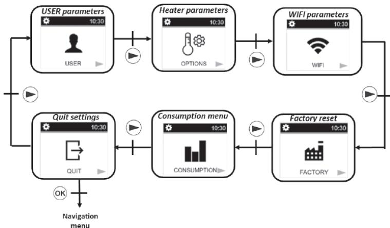
Pour sélectionner un menu, l'utilisateur doit appuyer sur la touche **OK**. la navigation est réalisée par la touche **▶**. Pour sortir du menu paramètres, l'utilisateur doit choisir le paramètre «SORTIR» et appuyer sur la touche **OK**.
