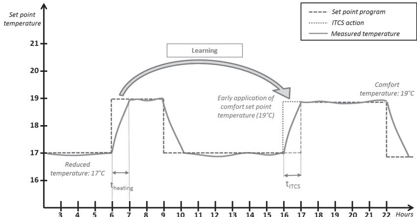
Pour fonctionner, le système ITCS réalise automatiquement plusieurs mesures de temps et de température. L'objectif est d'estimer une vitesse de chauffage du système. Avec cette valeur, le système peut calculer à l'avance le temps d'activation du chauffage.
