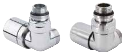
Valvole coassiali termostattabili con prerogolazione, bianche o cromate, attacco maschio 24x19 o femmina 1/2", sinistre o destre
