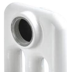
Prodotto con teste in acciaio stampato dello spessore di 1,5 mm e con tubi in acciaio del diametro di 25 mm e dello spessore di 1,1 mm.
