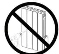
Les réparations exigeant l'ouverture du réservoir du liquide doivent être effectuées par le fabricant, par ses représentants ou par le service d'assistance à la clientèle.
