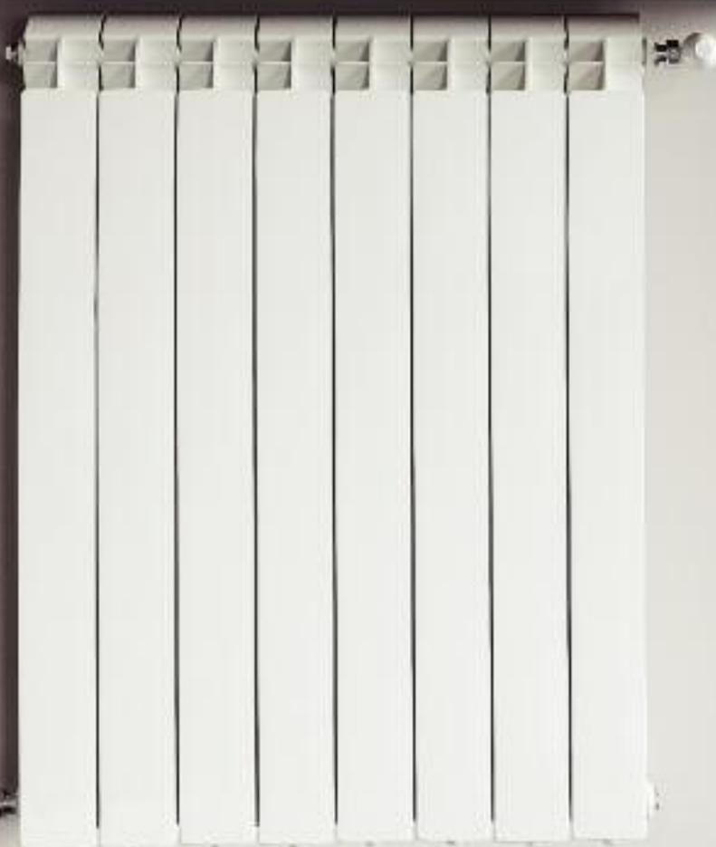
I radiatori Global hanno lunghissima durata grazie alla qualità del materiale impiegato (lega di alluminio certificata secondo la Norma EN AB 46100) ed alla doppia verniciatura a bagno anafresi e successivamente con polveri epossipoliestere.
