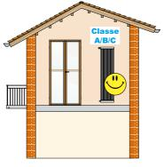
I radiatori a bassa temperatura sono il sistema di riscaldamento ideale per le nuove costruzioni in Classe A/B/C ad alto isolamento.
