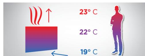
Nei sistemi tradizionali il calore è scambiato per convezione: l'aria scaldata, sale verso le zone alte della stanza e poi ricade raffreddandosi. Sulle zone più alte della stanza il calore è disperso attraverso i ponti termici.
