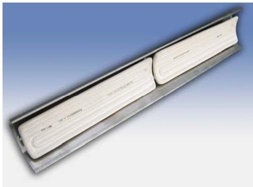
I pannelli RAD IC sono adatti per accogliere il montaggio degli irradiani curvi TIPO IC 123 x 60 e 245 x 60. Sono costituiti da una parabola riflettente in acciaio inox e da un supporto portante profilato ad U in acciaio alluminato. Su richiesta è possibile prevedere una scatola di protezione all'interno della quale racchiudere tutti i contatti elettrici (vedi soluzioni PANNELLO APERTO e PANNELLO CHIUSO in Figura 11)
