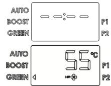
**Apagado:** para apagar el calentador de agua es suficiente presionar el botón ON/OFF. y permanece sólo la sigla "OFF" en el visor. La protección contra la corrosión sigue estando asegurada y el producto se encargará automáticamente de no permitir el descenso la temperatura del agua en el depósito por debajo de los 5°C.
