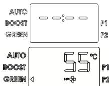
**Wyłączenie:** aby wyłączyć urządzenie należy nacisnąć przycisk ON/OFF, pozostaje jedynie widoczny komunikat "OFF" na wyświetlaczu. W tym trybie działa zabezpieczenie antykorozyjne zasobnika oraz zabezpieczenie przeciw zamrożeniowe, które nie pozwala na spadek temperatury poniżej 5°C.
