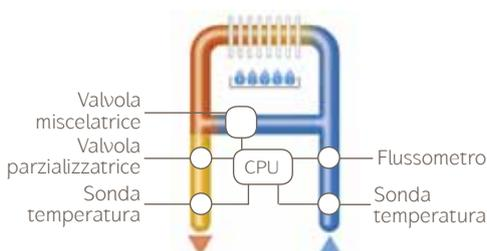
Il prodotto commerciale (24 e 32 l/min) racchiude le caratteristiche del prodotto domestico sfruttando inoltre una valvola miscelatrice al fine di stabilizzare ulteriormente e in modo più veloce la temperatura dell'acqua in uscita.
