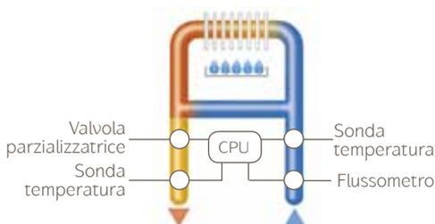
Nel prodotto domestico (11, 13, 16 l/min) la quantità di gas è erogata in base alle informazioni provenienti dal flussometro e dalla sonda di temperatura dell'acqua fredda e poi regolato ulteriormente dalle informazioni date dalla sonda di temperatura acqua calda.
