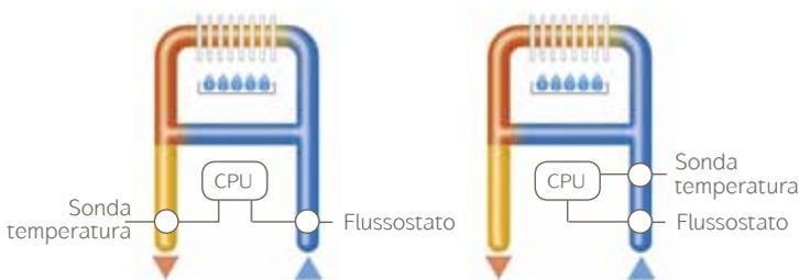
Prodotto standard in commercio dotato di flussostato e sonda di temperatura acqua fredda. Oppure dotato solamente di sonda di temperatura acqua calda in uscita. Queste soluzioni non permettono di avere un lead time ridotto per l'erogazione dell'acqua calda alla temperatura impostata.
