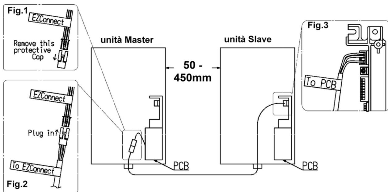
2. Rimuovete il cappuccio protettivo dal connettore a 3 pin marcato "EZ Connect" che si trova fra i cavi dell'unità Master (Fig.1)
