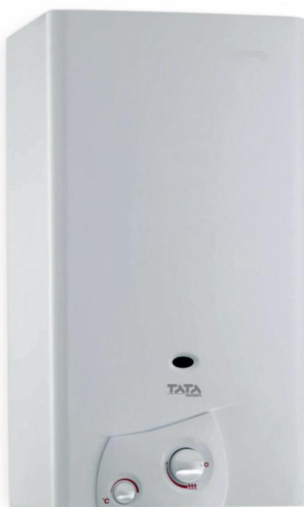
Scaldacqua a gas istantaneo a camera aperta dotato di valvola di modulazione che consente di mantenere costante la temperatura anche al variare della quantità di acqua richiesta, garantendo un'ottimizzazione dei consumi grazie al variare della potenza del bruciatore in funzione della portata d'acqua.
