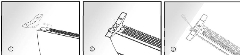
L'appareil est équipé d'un système anti-renversement qui produit un "clic" quand le thermoconvecteur est incliné: il est donc normal d'entendre un bruit à l'intérieur à chaque fois qu'on le déplace.
