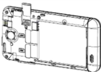
4. Inserire la batteria allineando i contatti dorati con i contatti nel vano batterie. Spingere delicatamente verso il basso la batteria finché non scatta in posizione.
