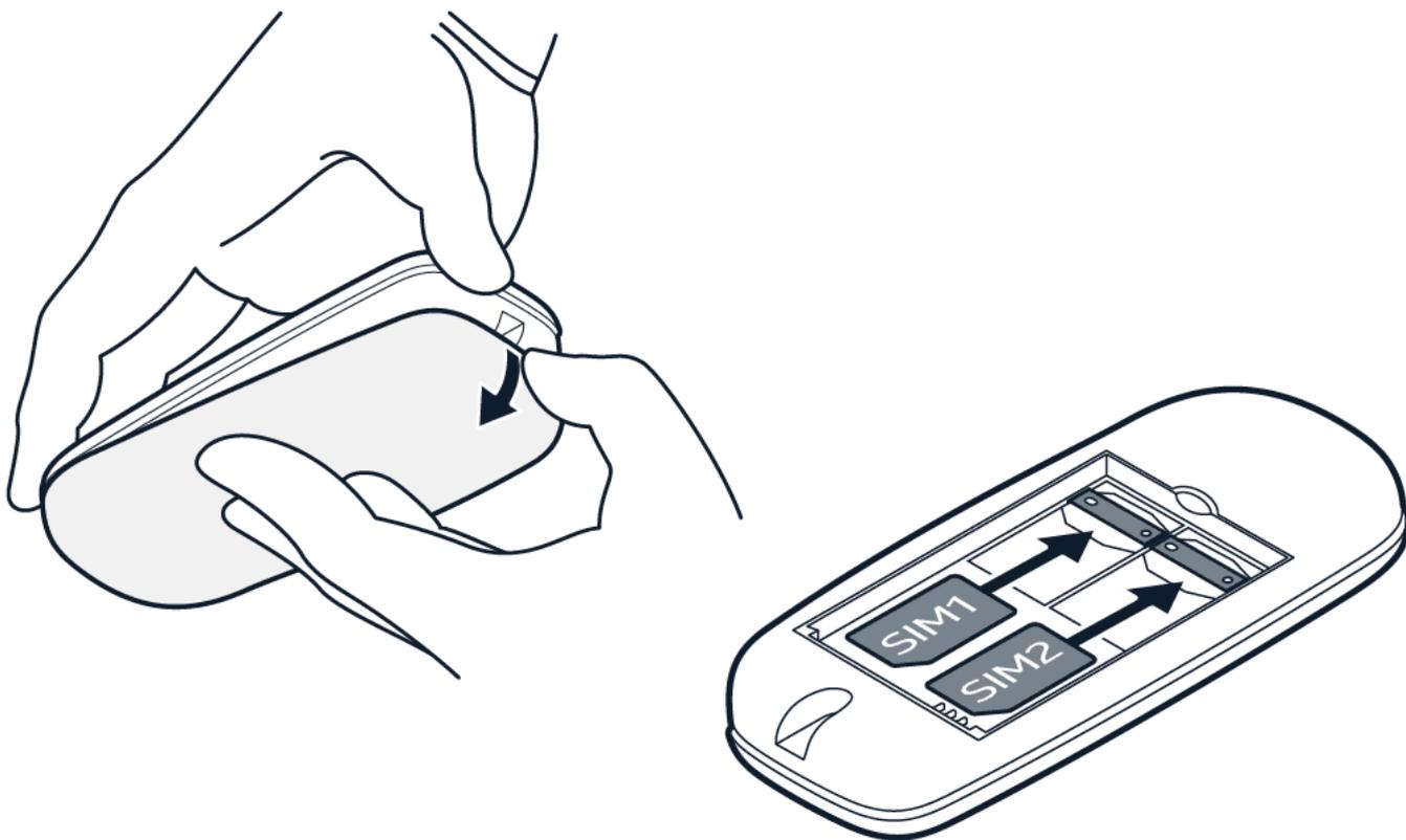
1. Posizionare l'unghia nello slot piccolo nella parte inferiore del telefono, sollevare e rimuovere la cover.
