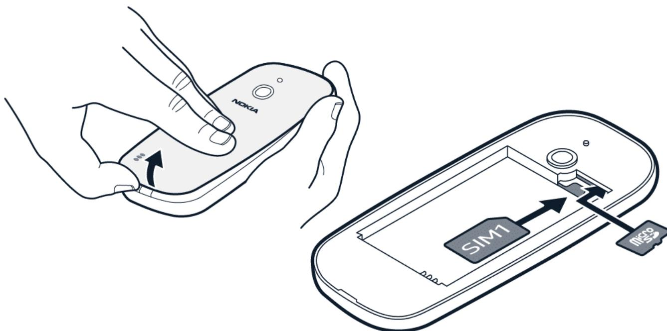
1. Posizionare l'unghia nello slot piccolo nella parte inferiore del telefono, sollevare e rimuovere la cover.
