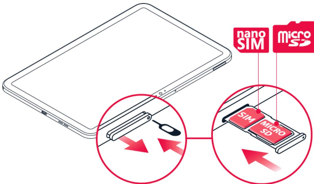
1. Aprire l'alloggiamento della scheda SIM: infilare la puntina per l'apertura nel foro dell'alloggiamento ed estrarre l'alloggiamento.
