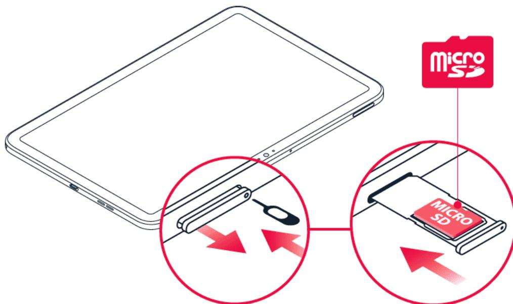
1. Aprire l'alloggiamento della scheda di memoria: infilare la puntina per l'apertura nel foro dell'alloggiamento ed estrarre l'alloggiamento.
