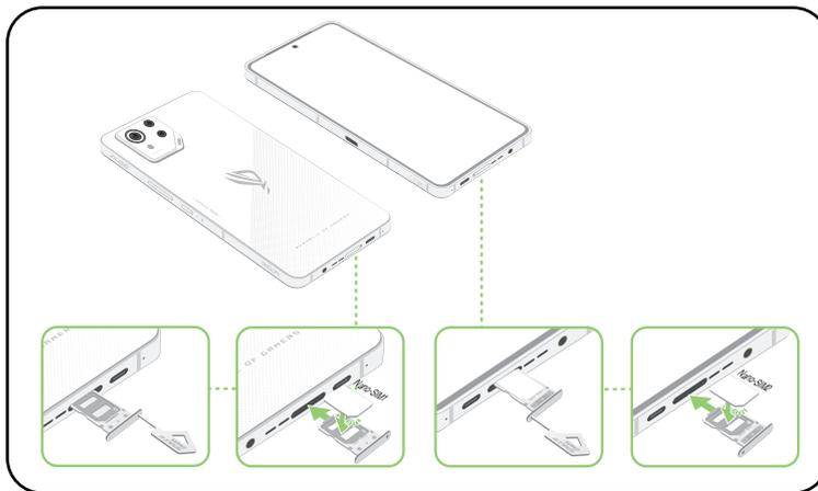
3. Spingete delicatamente il vassoio per inserirlo correttamente.
