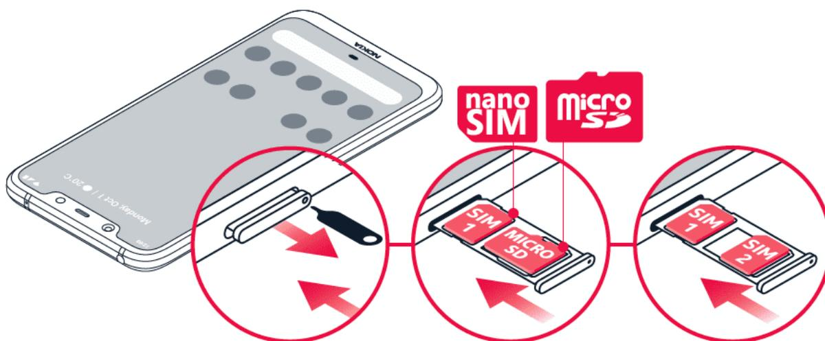
1. Aprire l'alloggiamento della SIM e della scheda di memoria: infilare la puntina per l'apertura nel foro dell'alloggiamento ed estrarre l'alloggiamento.
