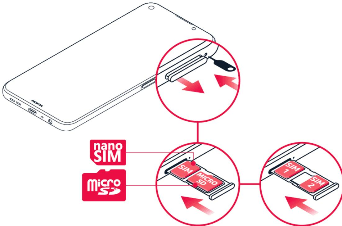
1. Aprire l'alloggiamento della scheda SIM: infilare la puntina per l'apertura nel foro dell'alloggiamento ed estrarre l'alloggiamento.
