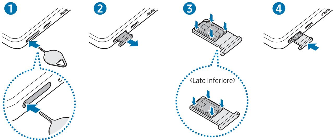
1 Inserite l'estrattore metallico nella fessura del supporto per allentarlo.
