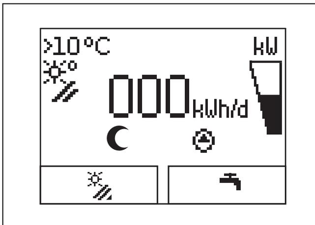
Nel normale stato operativo sul display compare l'indicazione di base. Essa visualizza lo stato corrente del sistema solare. Se la retroilluminazione del display era spenta, la prima pressione di un tasto la riaccende. Per eseguire la funzione correlata al tasto, esso deve essere premuto nuovamente.
