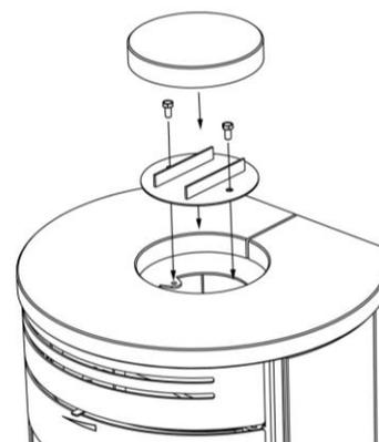
Per le stufe a legna Aduro si utilizzano tubi per i fumi di scarico con diametro di 150 mm.
