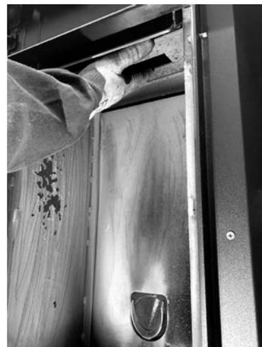
**Fig. 71 - Rimuovere la testa del focolare 1**
