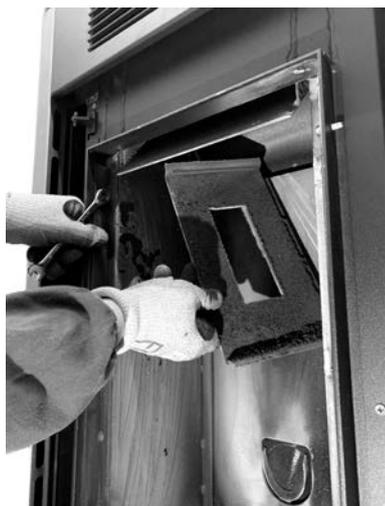
**Fig. 72 - Rimuovere la testa del focolare 2**
