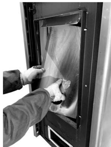
**Fig. 74 - Rimuovere la schiena del focolare**
