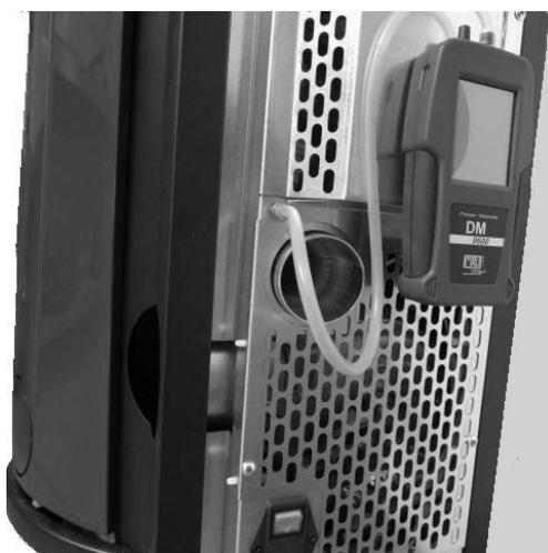
Fig. 63 - Collegamento pressostato digitale
