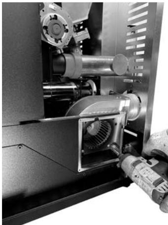
**Fig. 54 - Rimuovere viti ventilatore**
