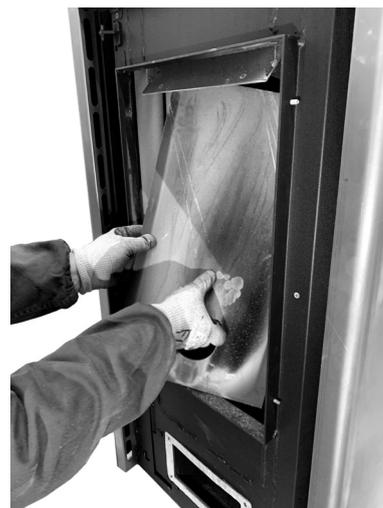
**Fig. 73 - Rimuovere la schiena del focolare**
