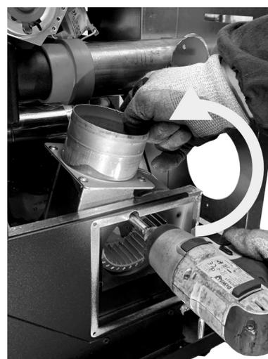
**Fig. 54 - Ruotare ventilatore**
