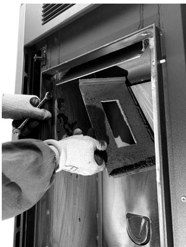
**Fig. 71 - Rimuovere la testa del focolare 2**
