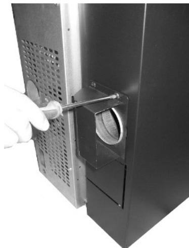
**Fig. 60 - Montaggio diffusore**
