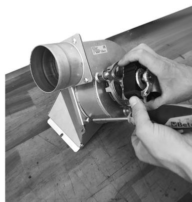
**Fig. 35 - Fissare con viti**
