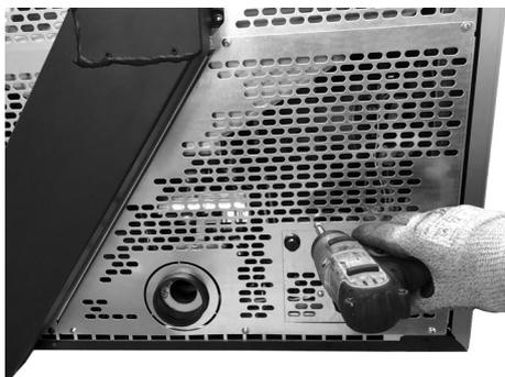
*Fig. 54 - Rimozione schiena MODO AT*
