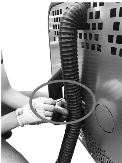
**Fig. 52 - Fissare con fascetta**
