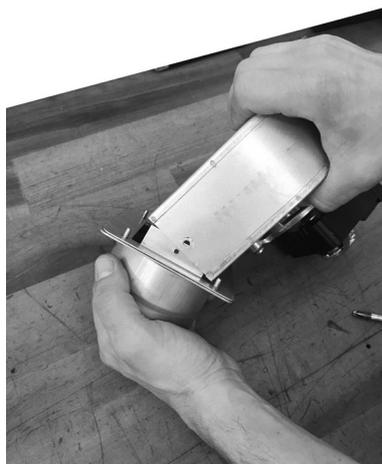
**Fig. 31 - Fissare flangia + raccordo al ventilatore**
