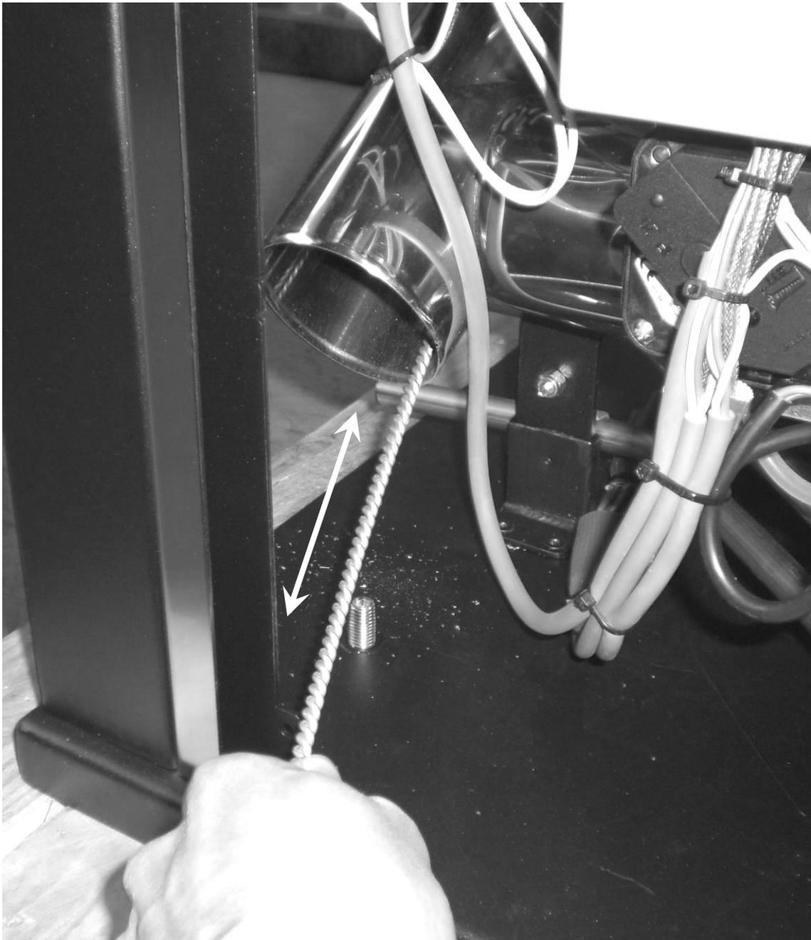
Pulire accuratamente con lo scovolo tutto il tubo in acciaio inox posteriore alla termostufa e rimontare il tappo ispezione del TEE in acciaio inox.
