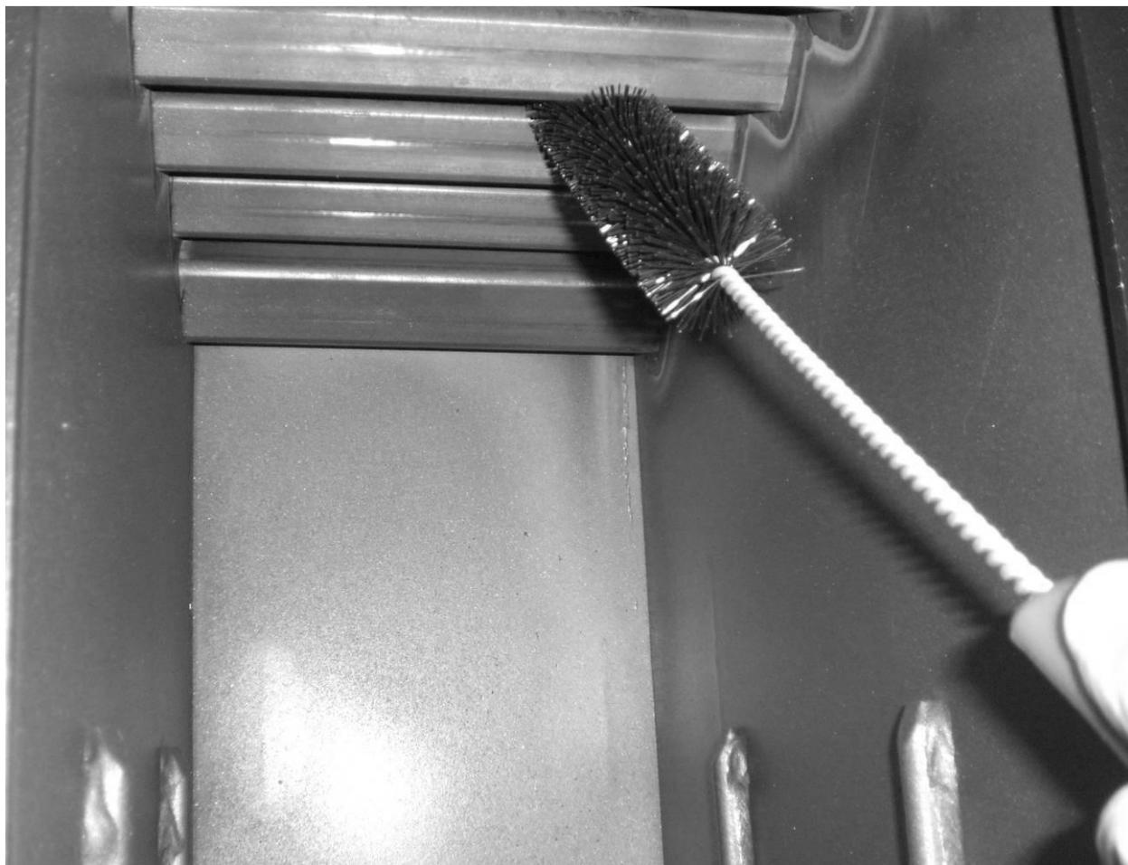
Con lo scovolo fornito in dotazione effettuare la pulizia degli elementi sopra la camera di combustione accedendo dalla stessa.
