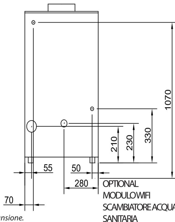
Mandata e ritorno variano, sia in altezza che dimensioni, in caso di Caldaia fornita con Scambiatore Rapido oppure di Caldaia fornita SENZA circolatore e vaso di espansione.
