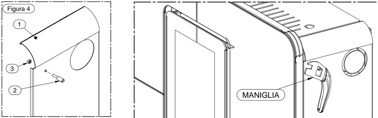
Per montare il gancio, smontare il fianco destro 1 della stufa (vedi paragrafo 4.3), posizionare nel foro il gancio 2 e bloccarlo con il dado 3. Riposizionare il fianco 1 sulla stufa.
