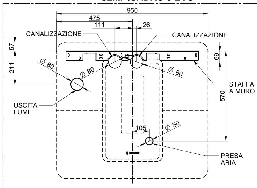
Appendere l'apparecchio alla staffa a muro A; una volta appeso l'apparecchio, appoggiarlo con forza a ridosso della parete e provvedere a riavvitare le viti di blocco B. In questa fase, prestare attenzione a fare coincidere i ganci di supporto (Vedi dettagli C e D della Figura 7).
