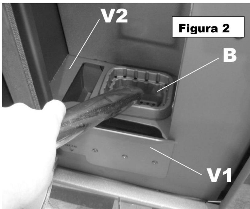
**MENSILMENTE** ispezionare e pulire l'apertura identificate con **V1**. Per accedervi aprire la porta, togliere il cassetto cenere ed alzare la lama di chiusura **L** (Figura 8).
