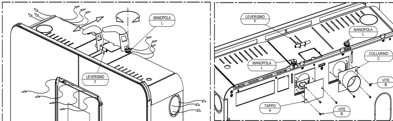
E' possibile distribuire l'aria calda anteriormente, lateralmente e posteriormente.
