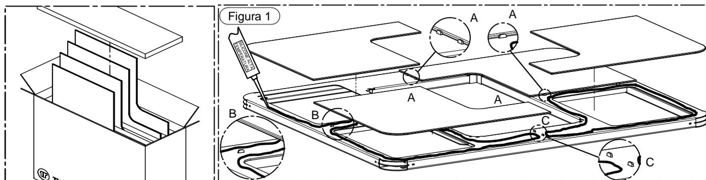
Per incollare i vetri sul pannello frontale, siliconare la superficie del frontale stesso mostrato in Figura 1. Attenzione: come evidenziato nel Dettaglio C, non siliconare le zone d'incrocio degli spigoli dei vetri. In caso contrario, il silicone potrebbe sbordare compromettendo l'estetica del prodotto.
