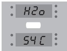
Per regolare la temperatura dell'acqua premere una sola volta il pulsante
