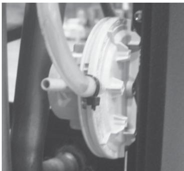
**Pressostato fumi:** controlla la pressione nel condotto fumario. Esso provvede a bloccare la coclea di caricamento pellet nel caso lo scarico sia ostruito o ci siano contropressioni significative ad esempio in presenza di vento. Nel momento di intervento del pressostato apparirà la scritta "ALARDEP-FAIL".
