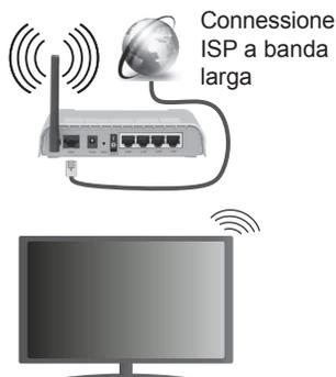
Per aumentare la larghezza di banda, è previsto un router N-wireless (IEEE 802.11a/b/g/n) con bande 2.4 e 5 GHz simultanee. Ottimizzato per uno streaming video HD più fluido e più veloce, trasferimenti file e gioco HD.
