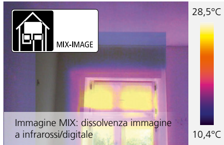
Immagine infrarossi con curva di temperatura dinamica
