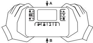
2. Inserire le 2 batterie alcaline 1.5 V tipo AA LR6 fornite assieme al Comando Remoto RF, verificando che l'orientamento sia corretto (indicazione visibile all'interno della parte anteriore).
